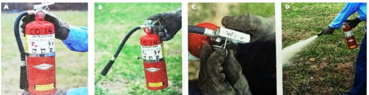
GAMBAR 12-25 Penggunaan alat pemadam api kimia kering. A. Periksa pengukur tekanan. B. Lepas selang, C. Tarik pin pengunci. D. Discharge di dasar api.
