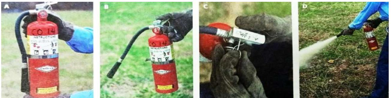
GAMBAR 10-25 Penggunaan alat pemadam api kimia kering. **A.** Periksa pengukur tekanan. **B.** Lepas selang, **C.** Tarik pin pengunci. **D.** Discharge di dasar api.
