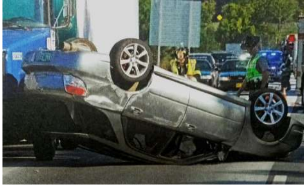
GAMBAR 12-22 Kendaraan yang diposisikan di atap atau sampingnya jelas tidak stabil.
