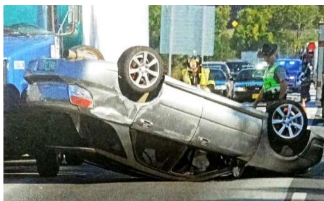
GAMBAR 10-22 Kendaraan yang diposisikan di atas atau sampingnya jelas tidak stabil.
