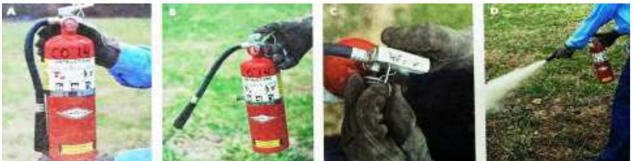
GAMBAR 10-25 Penggunaan alat pemadam api kimia kering. A. Periksa pengukur tekanan. B. Lepas selang, C. Tarik pin pengunci. D. Discharge di dasar api.
